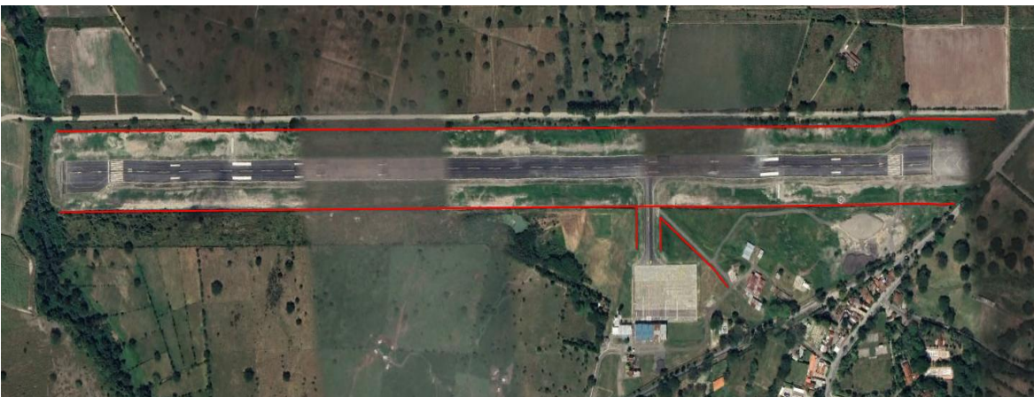
Imagen 4. Canales manejo de aguas lado aire pista 01 – 19
